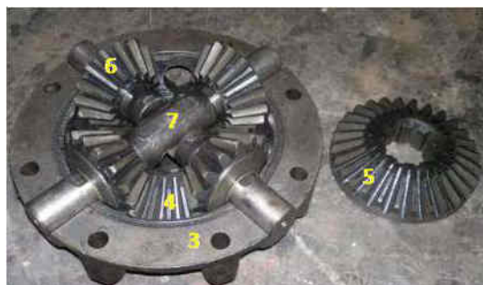
Fig. 5.21 – Diferențialul: 1 – pinion de atac; 2 – coroană conică; 3 – casetă; 4, 5 – pinioane planetare; 6 – sateliți; 7 – crucea (axul) sateliților; 8, 9 – arbori planetari
