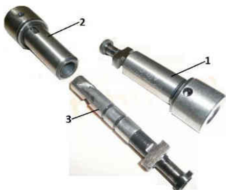
Fig. 4.40 – Element de pompare: 1 – element de pompare asamblat; 2 – cilindru; 3 – pistonas
