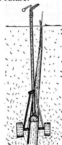
Fig. 7.10 – Schema instalației de udare prin aspersiune cu tractare longitudinală
