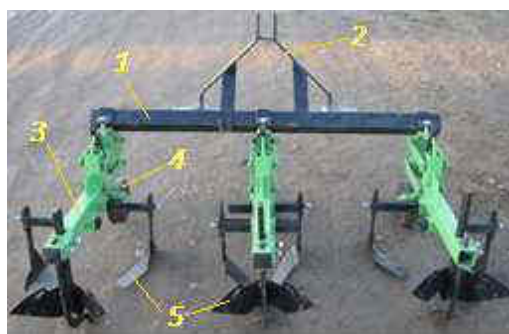
Fig. 4.1 – Cultivator pentru prășit: 1 – cadru; 2 – dispozitiv de cuplare; 3 – secție de prășit; 4 – roată de copiere; 5 – organe active
