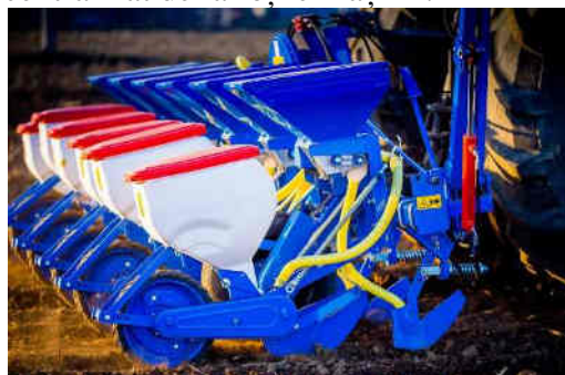
Fig. 3.15 – Semănătoare de precizie combinată SPC-6F
