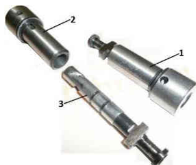
Fig. 2.35 – Element de pompă: 1 – element de pompă asamblat; 2 – cilindru; 3 – pistonas
