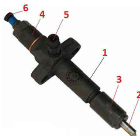
Fig. 2.44 – Injector de tip închis: 1 – corp metalic; 2 – duză; 3 – piuliță specială; 4 – capac de acces; 5 – racord intrare motorină; 6 – racord pentru scăpări de motorină
