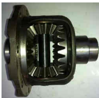
Fig. 2.85 – Diferențial cu doi sateliți
