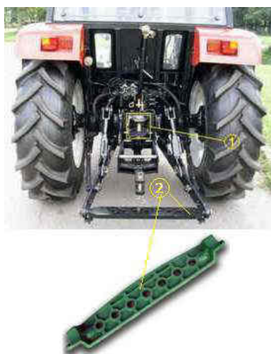
Fig. 4.2 – Bara de tracțiune transversală: 1 – cuplă simplă; 2 – bară transversală
