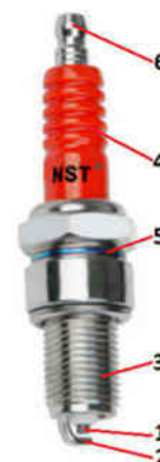
Fig. 2.63 – Bujie: 1 – electrod central; 2 – electrod lateral; 3 – corp metalic filetat; 4 – izolator ceramic; 5 – garnituri de etanșare; 6 – piuliță
