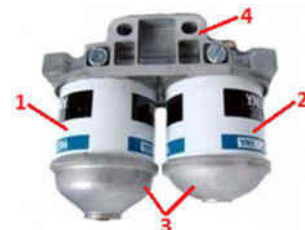
Fig. 2.29 – Baterie de filtre de combustibil: 1 – filtru brut; 2 – filtru fin; 3 – capace; 4 – corp
